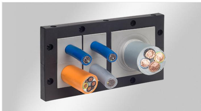
Le cadre d'introduction de câbles, le KEL 183, permet d'introduire des câbles et gaines flexibles jusqu'à un diamètre de 75 mm (en fonction du type de cadre) avec une étanchéité IP54 / UL Type 12.
